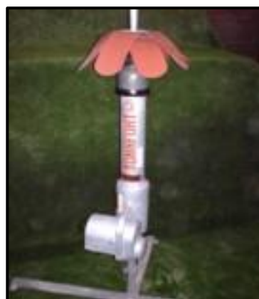
Figure 15 : Cloche et leurre d'un canon Tonnefort 5
